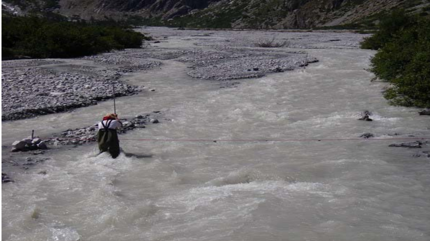
Mesure à l'aide d'un Helley-Smith « portable » sur un torrent des Alpes
