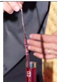
Photo3. Le système capillaire d'un arbre peut être schématisé par une pipette Pasteur (une grosse veine suivie par un capillaire). Si on plonge cette pipette dans un liquide coloré, il monte de 2 à 3 cm dans le capillaire.
