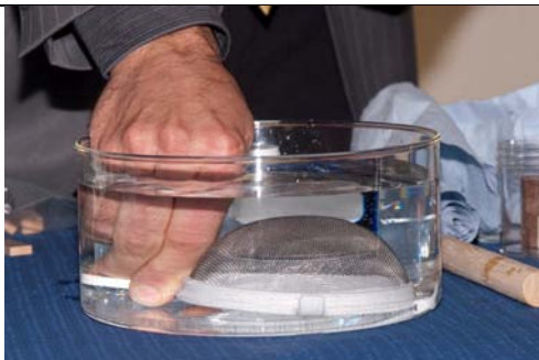
Photo 2. Lorsqu'on plonge une passoire sèche dans l'eau bien horizontalement, l'air s'échappe par les mailles de la passoire le liquide occupe tout l'espace à l'intérieur de la passoire. Si on recommence l'opération, la passoire est mouillée et les mailles ne sont plus perméables à l'air. En la plongeant à nouveau dans l'eau, on emprisonne une grosse bulle d'air, en forme de calotte, dans le haut de la passoire.
